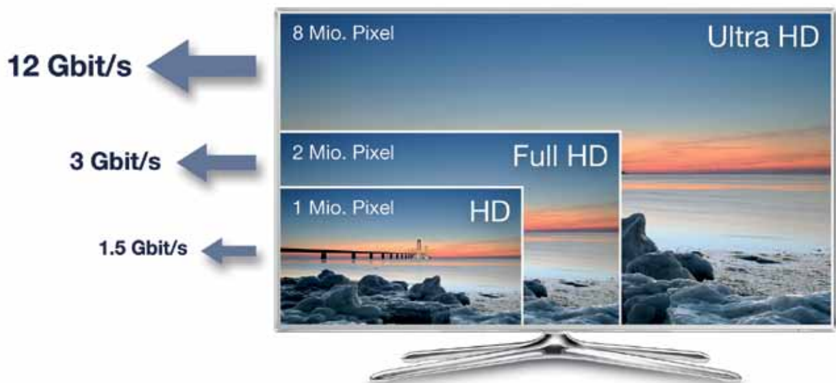
Bild 1. Vergleich der Auflösungen und resultierenden Datenraten moderner Displays. (Bild: Rosenberger)
